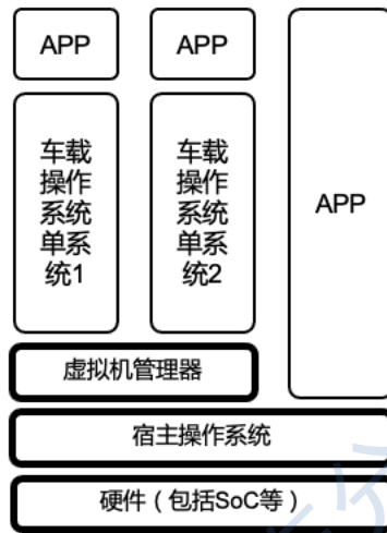
图7 虚拟机管理器Type-2 + Application 混合架构
