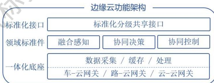
图 3.4 边缘云功能架构
