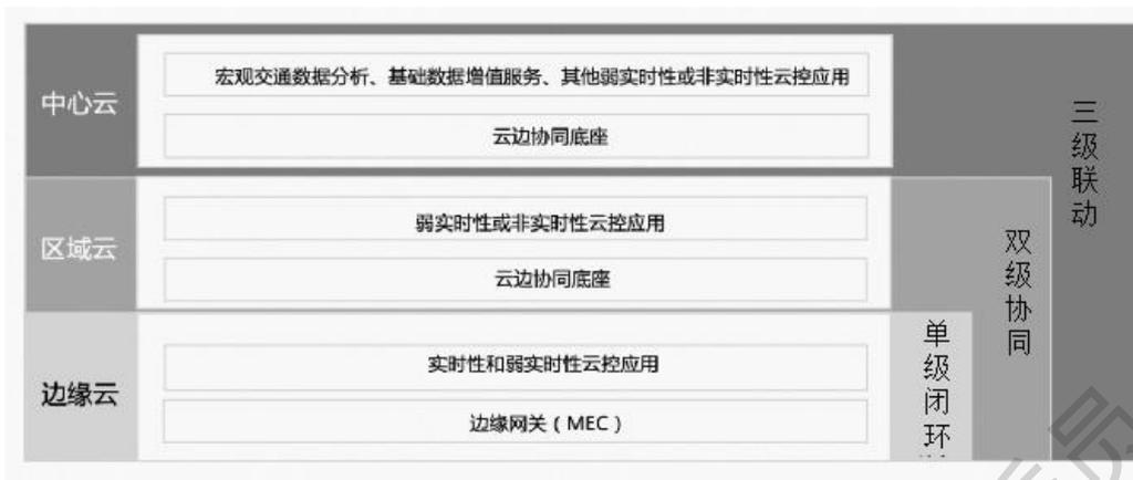
图 3.7 三级云协同架构
